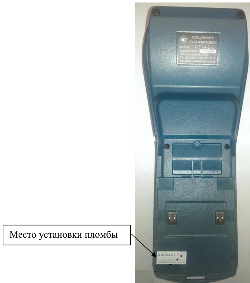
Рисунок 2 - Место пломбирования толщиномеров и место наклейки ярлыка
